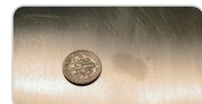
客户换用 **Cross DC 181** 后，解决了容易出现黏模的问题，生产效率提高，并将稀释比例增大到 1:100，铸件表面更加光亮。
